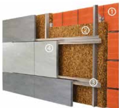
Stratigrafia di una parete ventilata
